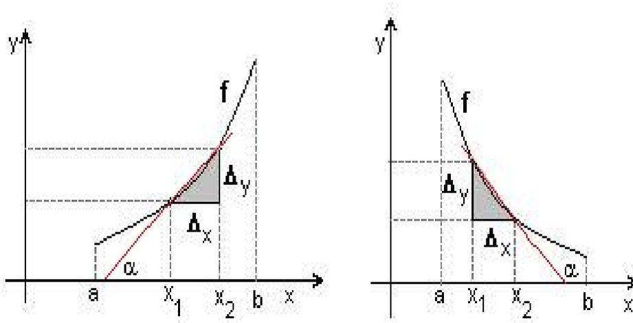
fig. 4.1-Variação média é o coeficiente angular da reta que une os pontos  $(x_1, f(x_1))$  e  $(x_2, f(x_2))$
