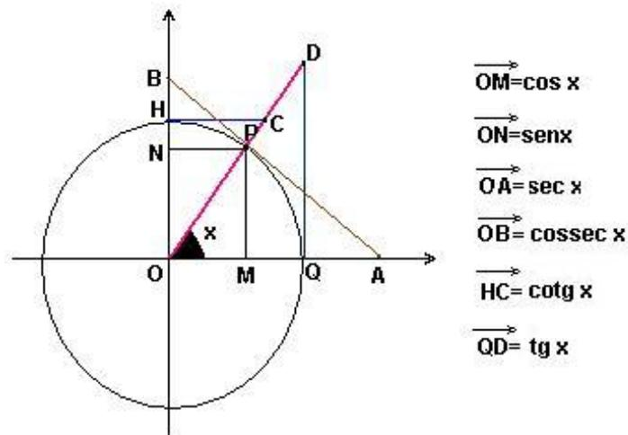
fig.2.19-Esquema geométrico das funções trigonométricas
